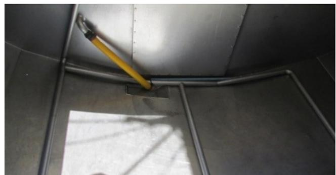
**Figura 4.** Sistema de bodega de acero inoxidable, con agua circulante utilizadas por las embarcaciones tramperas para el transporte de crustáceos bentónicos (Fotografías: Mauricio Sáez).
