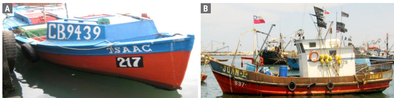
Figura 10. a) Lancha espinelera menor a 12 metros de eslora, b) Lancha espinelera mayor a 12 metros de eslora.
