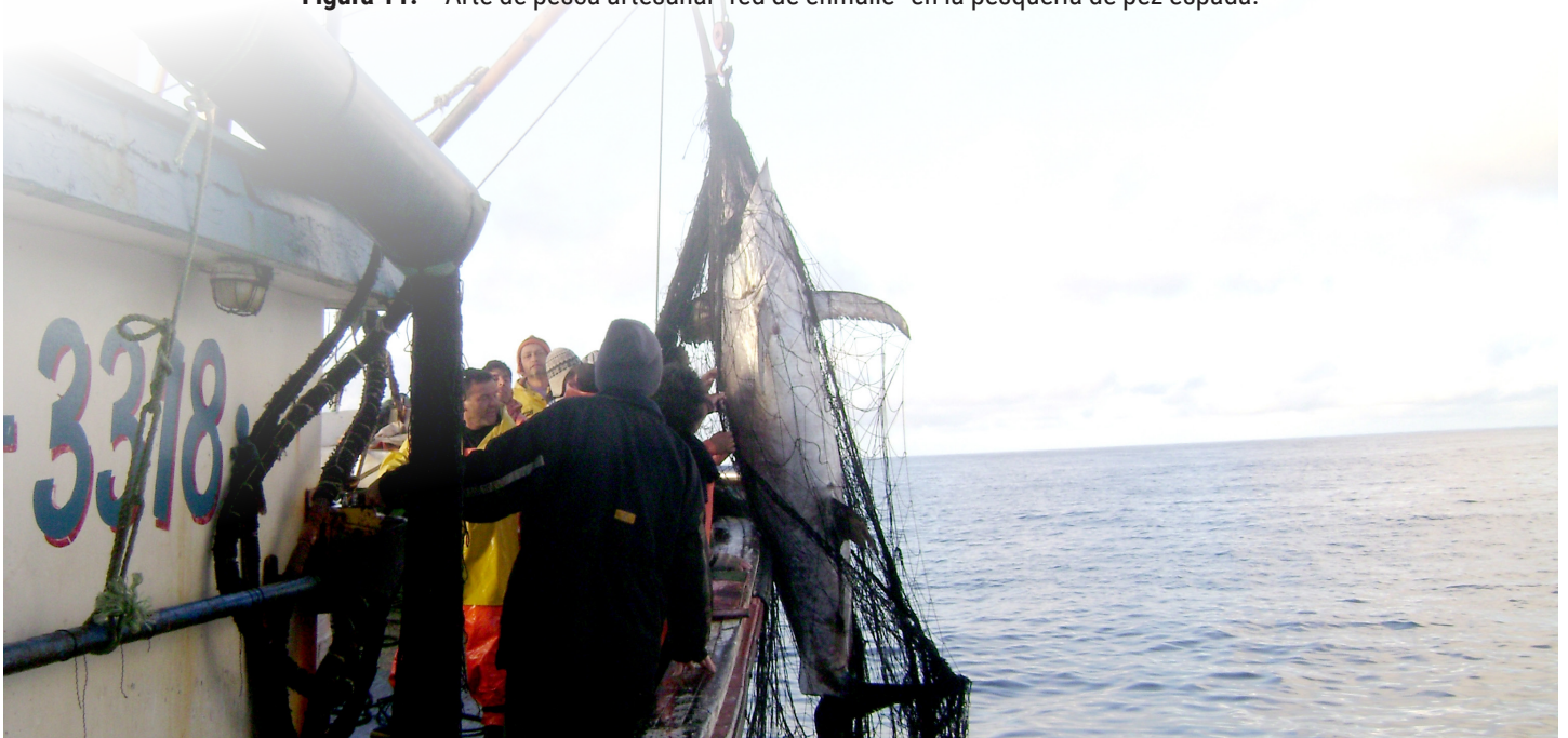
Figura 11. Arte de pesca artesanal “red de enmalle” en la pesquería de pez espada.
