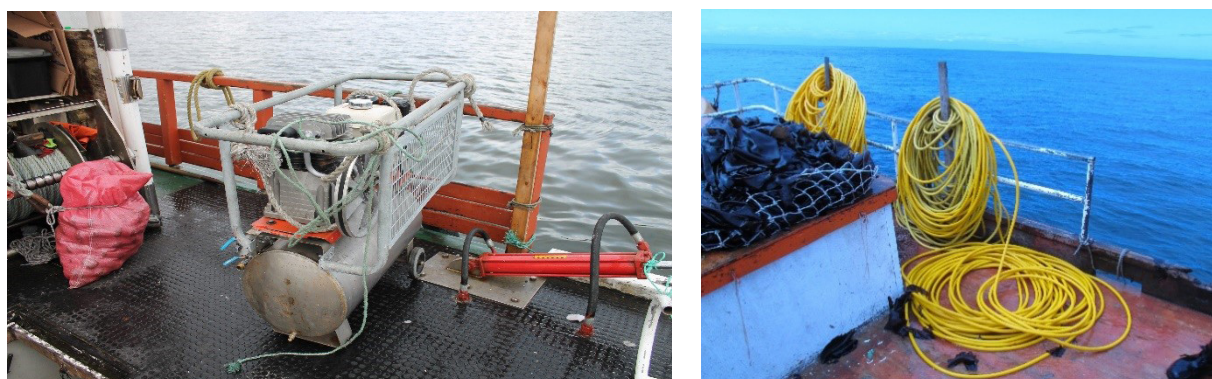
Figura 7. Sistema de buceo semi-autónomo Hoocka. Izquierda: se observan el motor, compresor y el acumulador de aire. Derecha: la manguera amarilla de 9 mm y 100m de largo. (Fotos: Paulo Mora).
