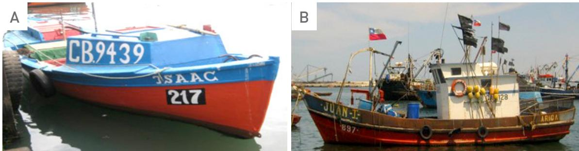
**Figura 11.** a) Lancha espinelera menor a 12 metros de eslora b) Lancha espinelera mayor a 12 metros de eslora.
