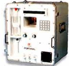
La salinidad se puede medir con un salinómetro o con un refractómetro
