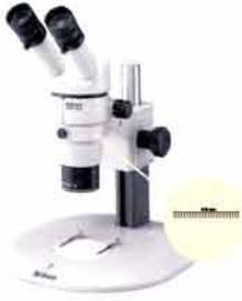
Fig. 30: Estereomicroscopio: Este instrumento se usa para observar objetos que no son transparentes; el factor de magnificación más común es entre 25 y 100 veces; a su interior se pueden colocar escalas ópticas, para efectuar mediciones directas "en pantalla" (Fuente: NIKON)
