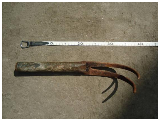
Figura 7. Garra empleada en la zona norte del pa3s principalmente para la extracci3n de recursos s3siles.
