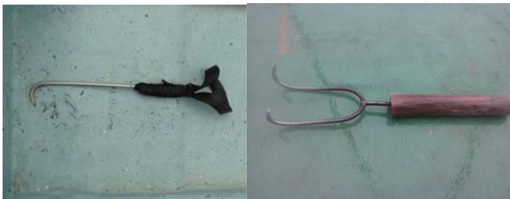
Figura 27. Ganchos utilizados en la extracción de erizo. En el caso del primero también es utilizado en la extracción de locos.
