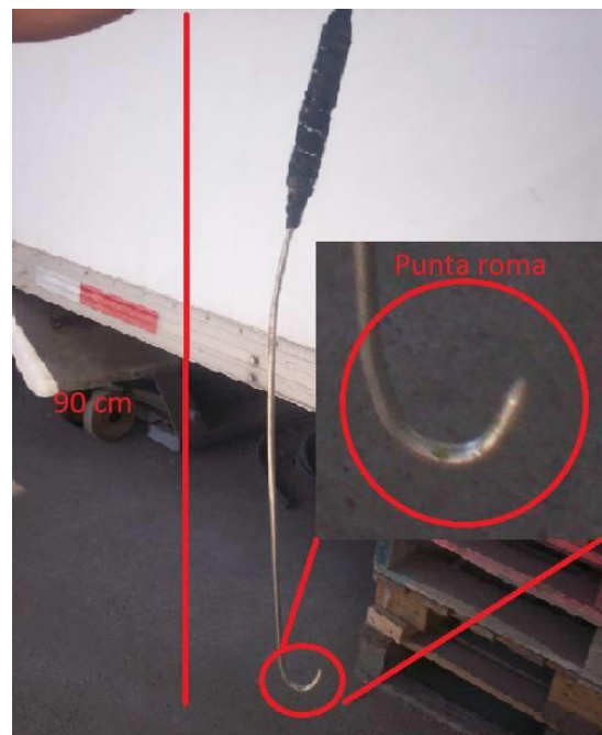
Figura 10. Gancho utilizado en la extracción de pulpos por los buzos mariscadores de la Región de Atacama.
