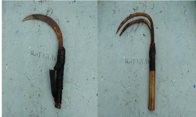
Figura 26. Ganchos para extracción de almeja, culengue y tumbao.
