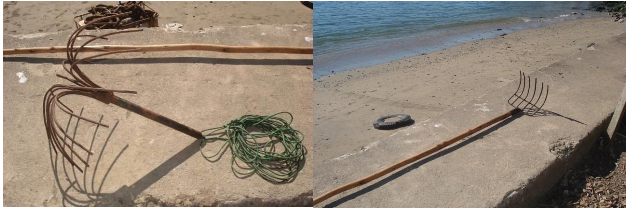
Figura 17. Accesorios utilizados en la extracción de algas: Araña (Izquierda), Gancho con varilla (Derecha)
