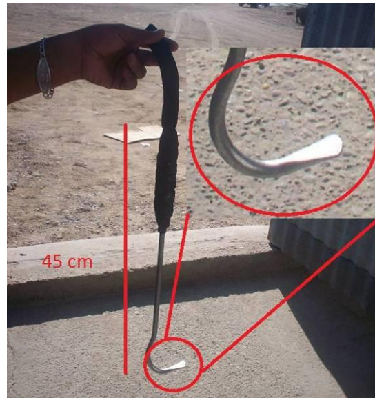
Figura 9. Gancho utilizado en la extracción de lapas y erizos por los buzos mariscadores de la Región de Atacama.
