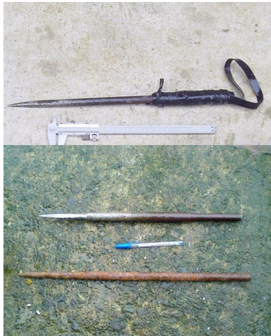
Figura 25. Punzones utilizados por buzos mariscadores para picar y luego remover picoroco. Caleta Carelmapu, Región de Los Lagos. Fotografías: Raúl Serón G., Débora Sánchez P. y Ma. Soledad Hernández B. IFOP- Carelmapu.
