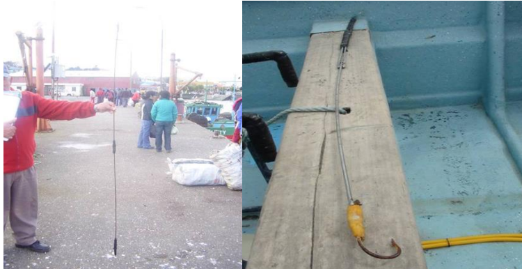
Figura 28. Gancho utilizado para la extracción de pulpo.
