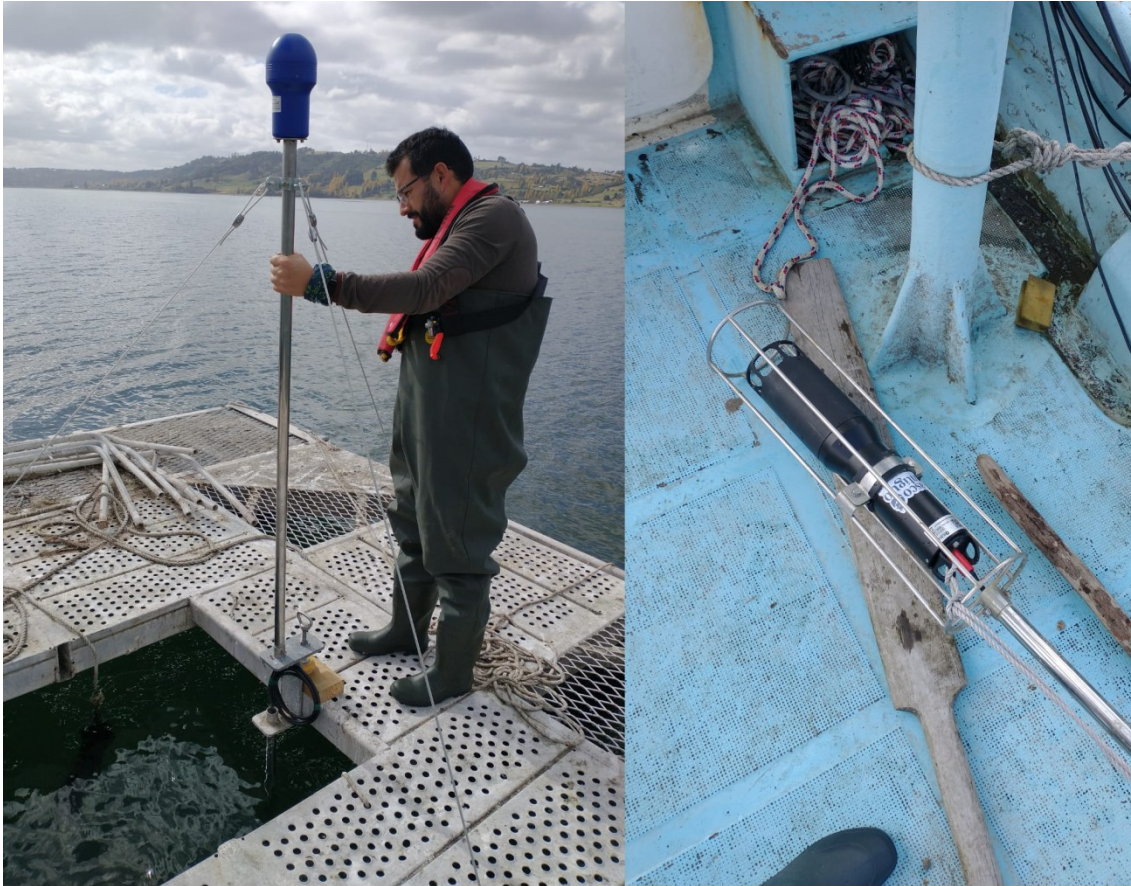
Figura 4: Instalación de la sonda multiparámetro WIMO sumergida a 1.5 m de profundidad en el humedal de Putemún.
