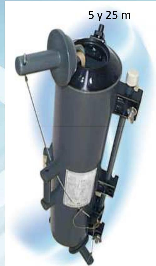
Equipos de muestreo de sedimentos y columna de agua
